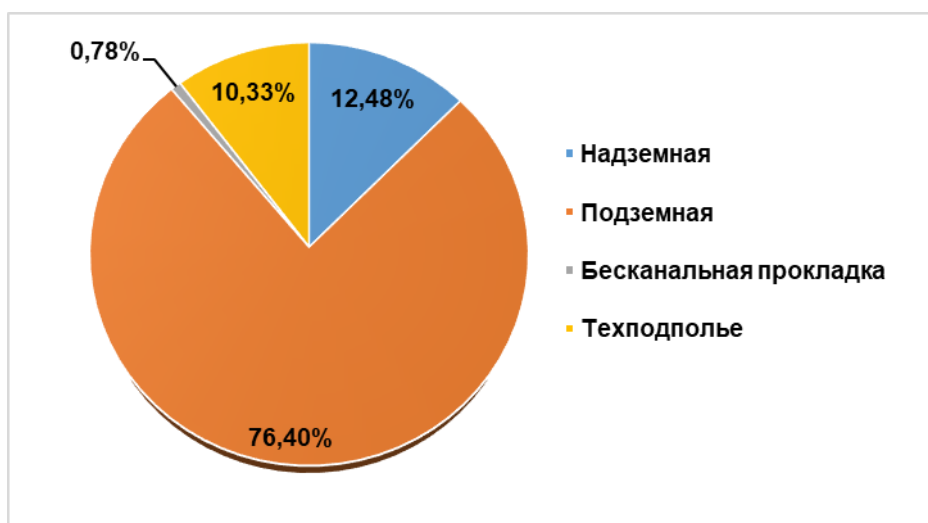
Рисунок 3.4 – Распределение протяженности трубопроводов тепловых сетей Стерлитамакского РТС по типам надземной и подземной прокладки на 01.01.2026 г.
